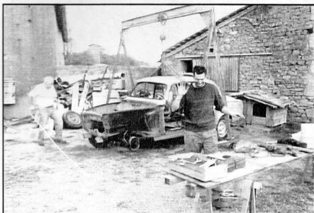
La voiture est ensuite placée sous le palan pour le démontage des train et la mise sur plateau.
