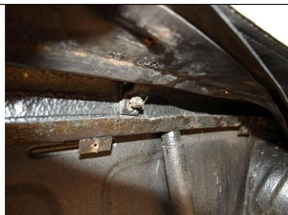
Une fois les 7 écrous enlevés, dégager la capote et poser l'armature arrière sur le coffre
