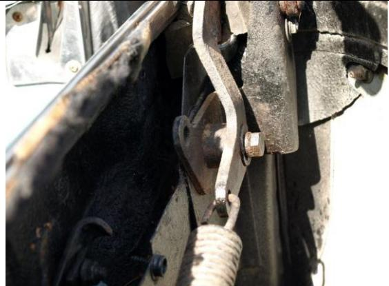
Enlever le boulon de 10mm à l'aide d'une clé à cliquet et d'une clé à œillet. Ce boulon est présent du côté droit et gauche de l'armature et il est situé au dessus de l'axe que vous venez de démonter.
