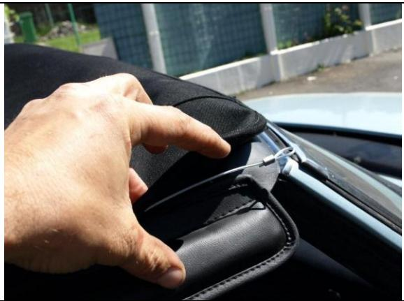
Positionner la capote à sa place dans le bac à capote. Centrer la capote en contrôlant le positionnement de la vitre sur le bourrelet d'étanchéité à droite et à gauche. Resserrer les pattes de fixation en coinçant les 2 barres insérées préalablement dans la capote. (Ne pas serrer totalement pour permettre l'ajustement latéral)
