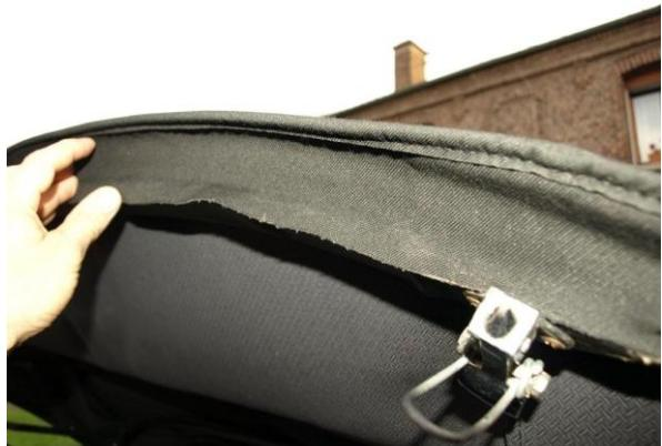
Décoller les bandes autocollantes intérieures, les enrouler autour des barres d'armature. Il est conseillé de mettre un peu de néoprène sur ces bandes.
