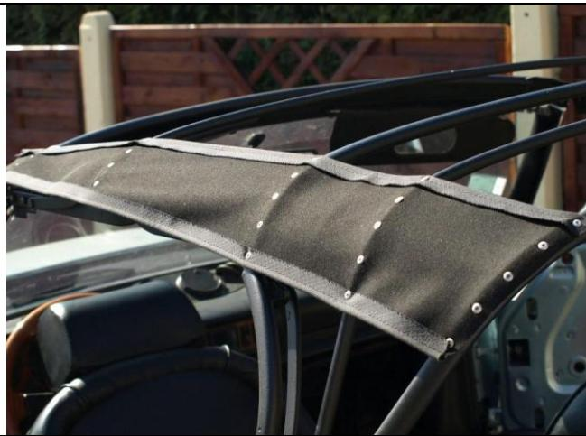
Positionner la capote à sa place sur l'armature en passant l'avant de l'armature dans la capote. Passer le câble dans l'orifice prévu à cet effet.
