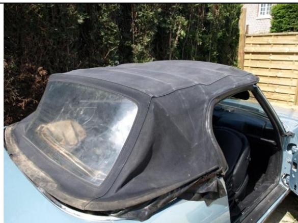
Relever l'arrière de la capote sur le toit pour permettre d'accéder facilement au câble tendeur
