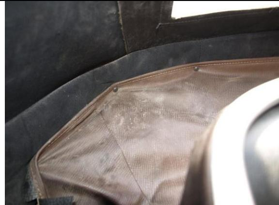
Desserrer les 7 écrous de fixation basse de l'armature à l'aide d'un clé à cliquet équipée d'une douille de 10mm. Ils se trouvent à l'arrière sous la « jupe » de la capote coté bac à capote
